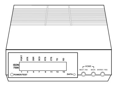
Figure 21-9. The 7500B Data Module
